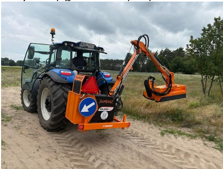
Zdjęcie 19. Kosiarka bijakowa z wysięgnikiem do koszenia poboczy
